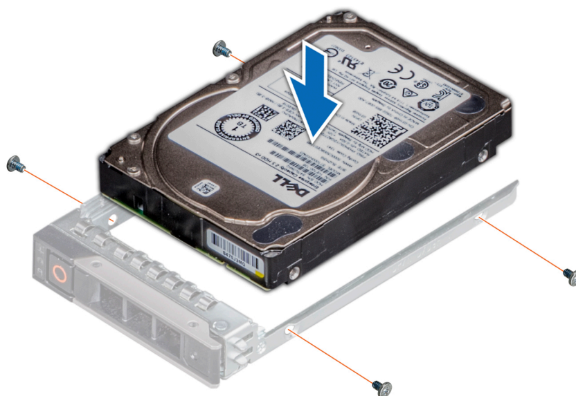
図 35. ハードドライブキャリアへのハードドライブの取り付け
